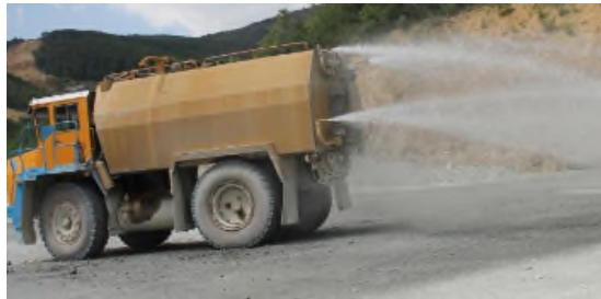
BAGNATURA VIABILITA' DI CANTIERE
